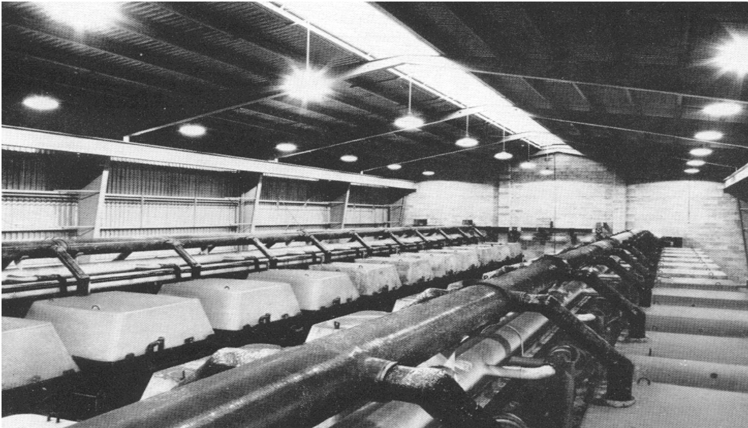
Figura E.9 - Una sala di celle a diaframma (Hooker Chemical Corp., New York)
